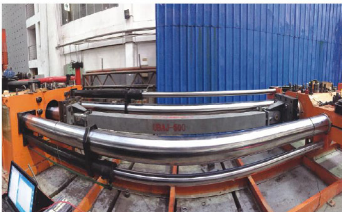
屈曲约束支撑试验
